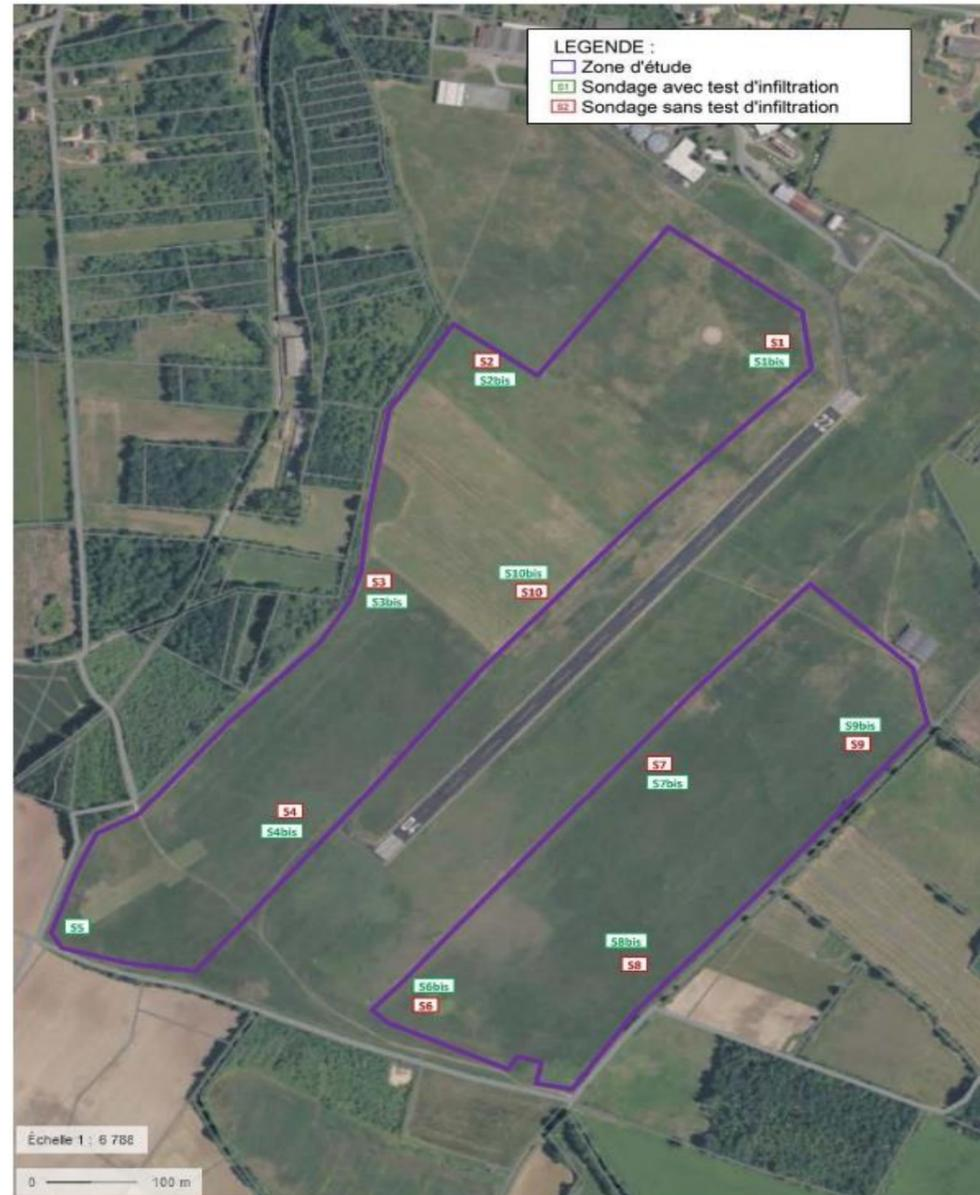
Figure 16 : Localisation des sondages réalisés sur site
